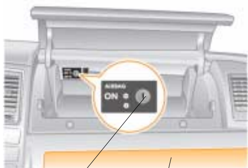
Airbagschalter im Handschuhfach (Multivan)
