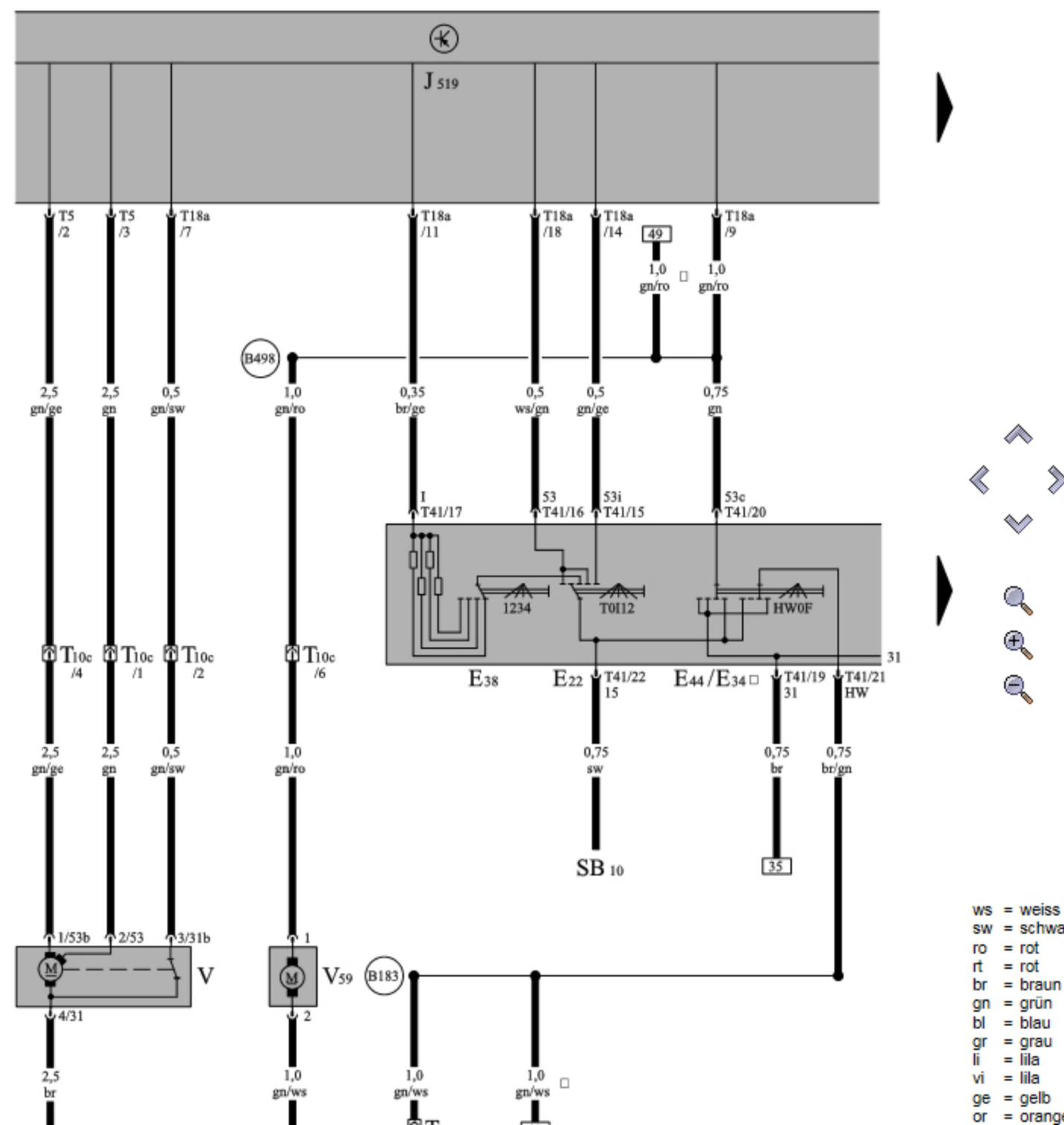
**Bordnetzsteuergerät, Scheibenwischerschalter für Intervallbetrieb, Scheibenwischermotor, Frontscheibenwasch- und Heckscheibenwaschpumpe**
