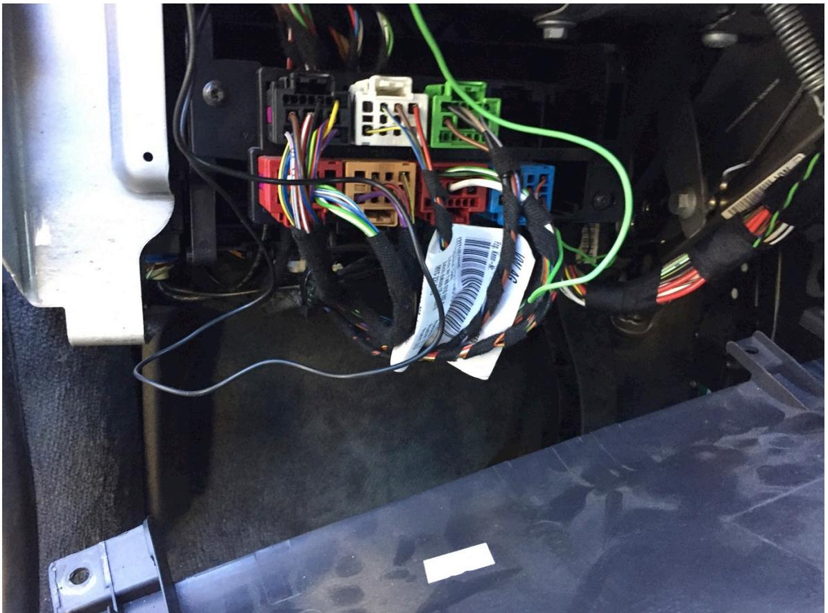
Aus 5 x ca. 5 m Litze einen eigenen Kabelbaum basteln und aus dem Fahrerfußraum über die A-Säule zur B-Säule (Fahrerseite) ziehen bzw. schieben:
