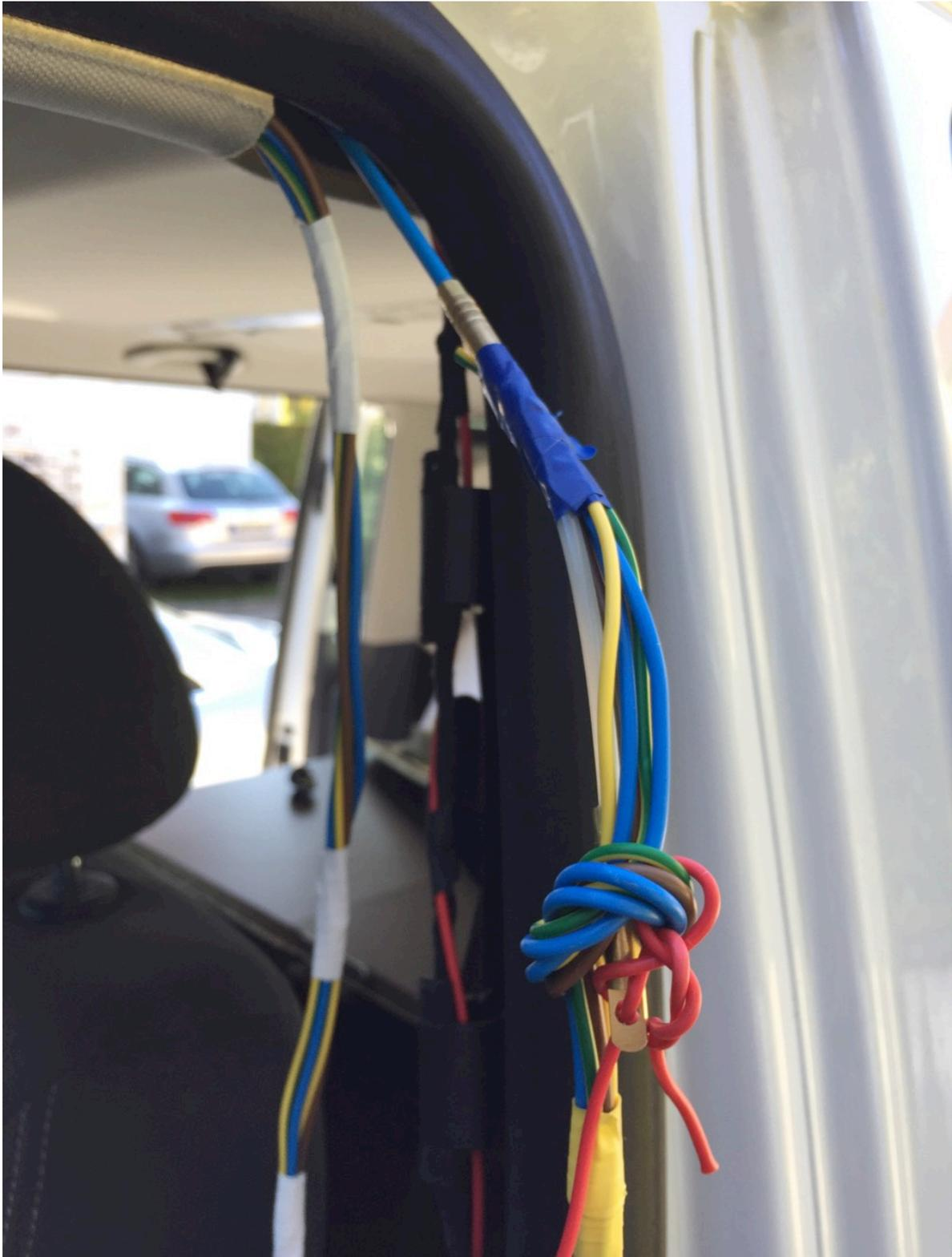
In der B-Säule Beifahrerseite am vorhandenen Kabelbaum und unter dem Gurt entlang nach unten führen; Kabelenden abisolieren und mit isolierten Kabelschuhen bestücken:
