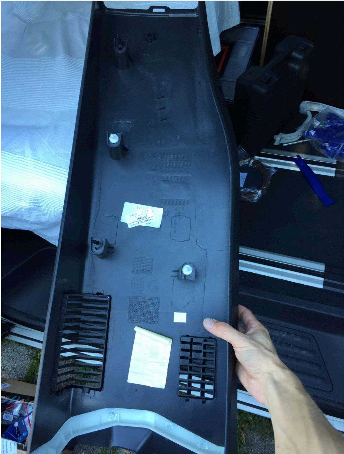
Cockpit-Verkleidung an der Fahrerseite seitlich (nur gesteckt) und im Fußraum lösen (4-5 T20 Schrauben), um an die Kupplungsstation A-Säule zu kommen:
