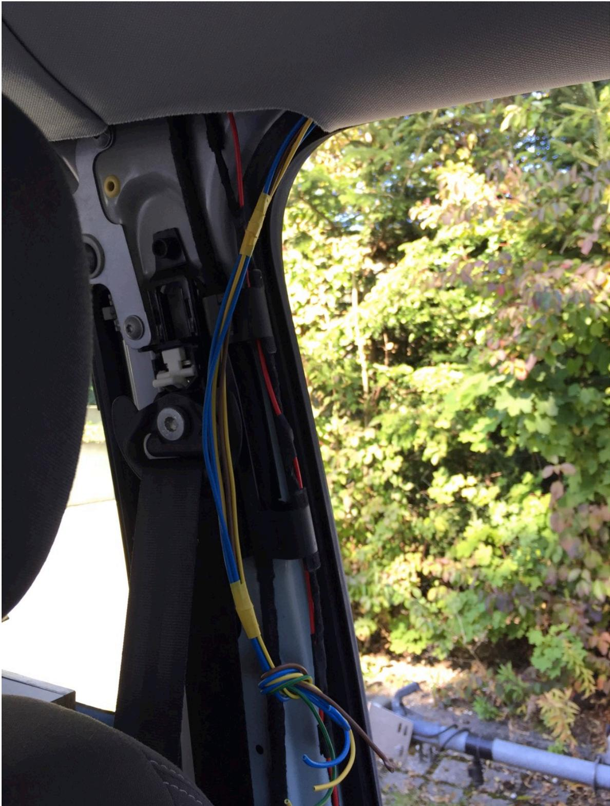
Mit der Kabeleinzieh-Hilfe den neuen Kabelbaum sowie ein mit 7,5 A abgesichertes Kabel vom Pluspol der zweiten Batterie (auf dem Bild das rote Kabel) durch den Himmel rüber zur B-Säule Beifahrer ziehen:
