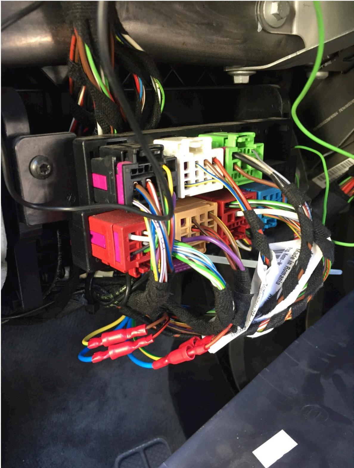
Batterie(n) anklemmen; die Kabelschuhe an der B-Säule durchmessen und an den Schalter stecken, Funktion testen:
