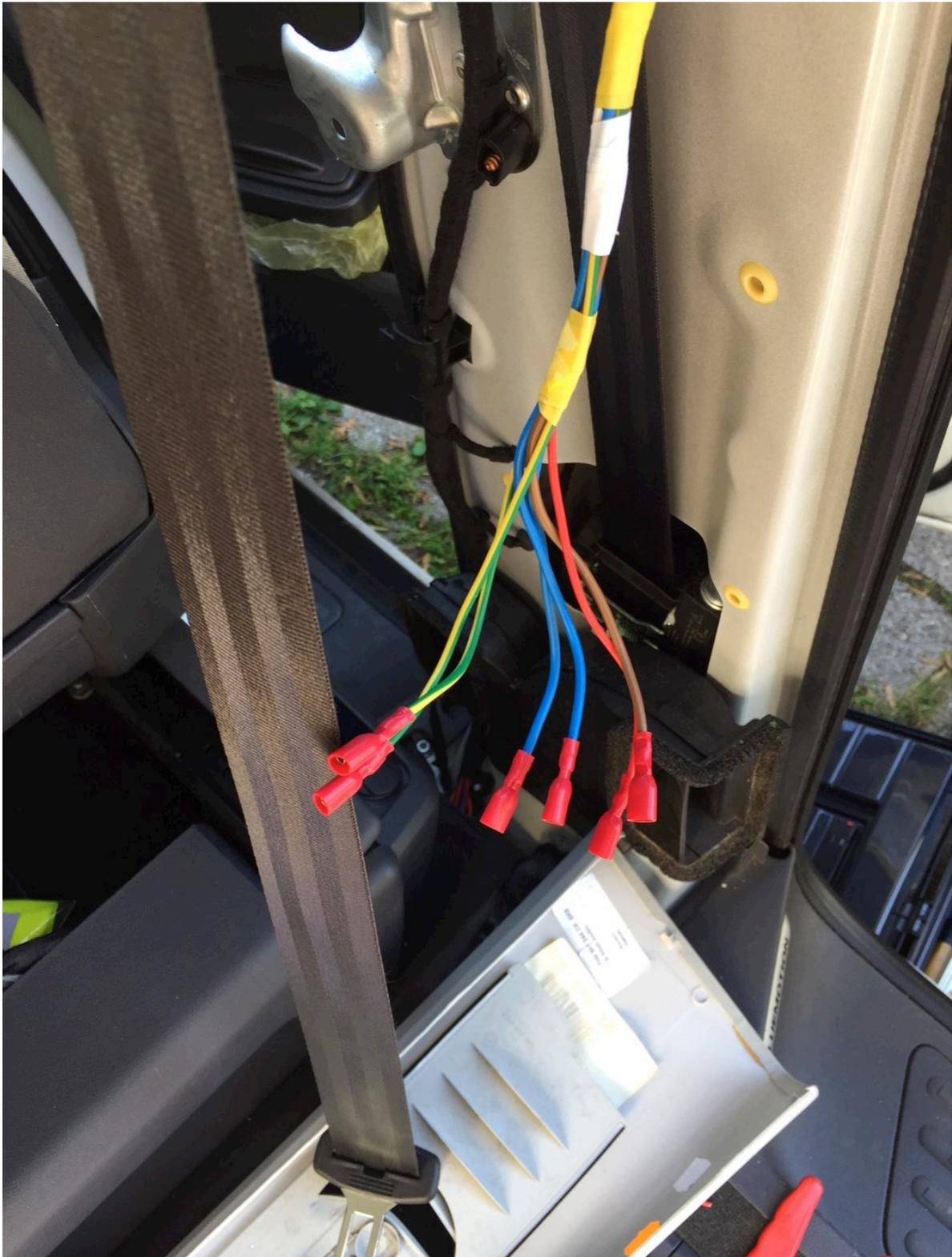
Mit dem Stufenbohrer ein 20 mm Loch in die untere Verkleidung der Beifahrer-B-Säule bohren; Schalter einsetzen:
