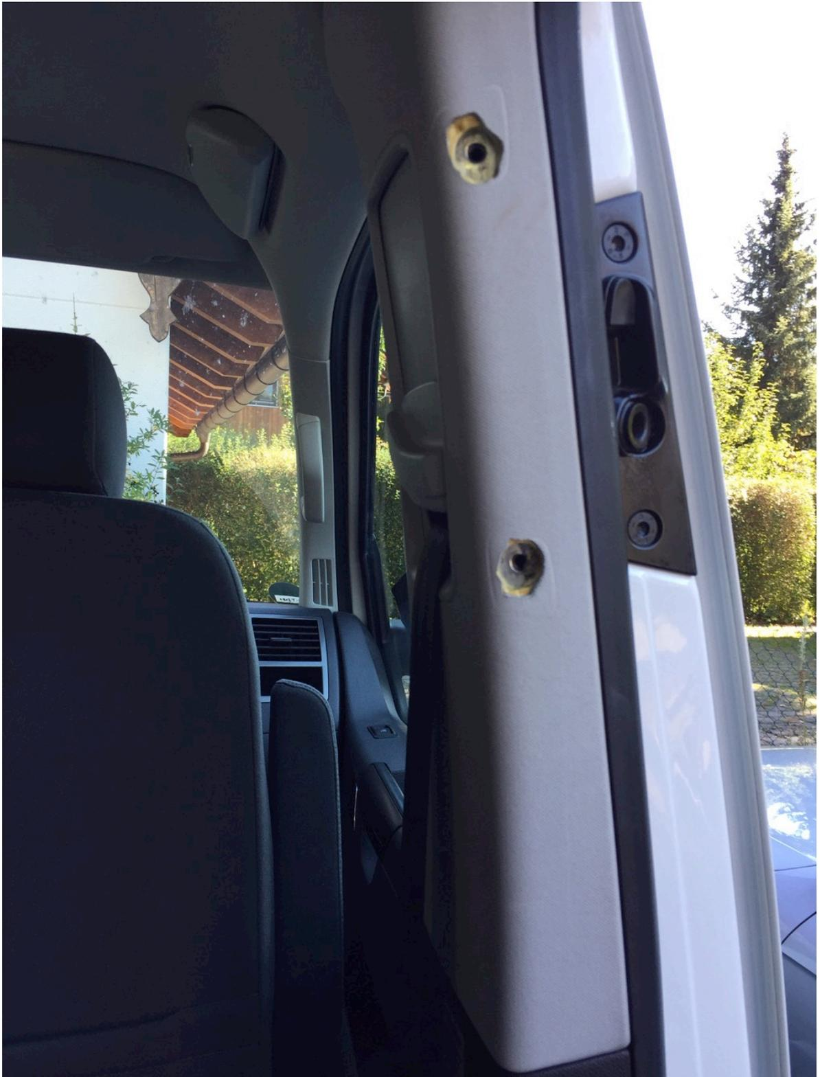
Verkleidungen A-Säule (vorher Lautsprecherabdeckung abhebeln), B-Säule Fahrer (oben) und B-Säule Beifahrer (oben und unten) entfernen (sind nur geclipst):
