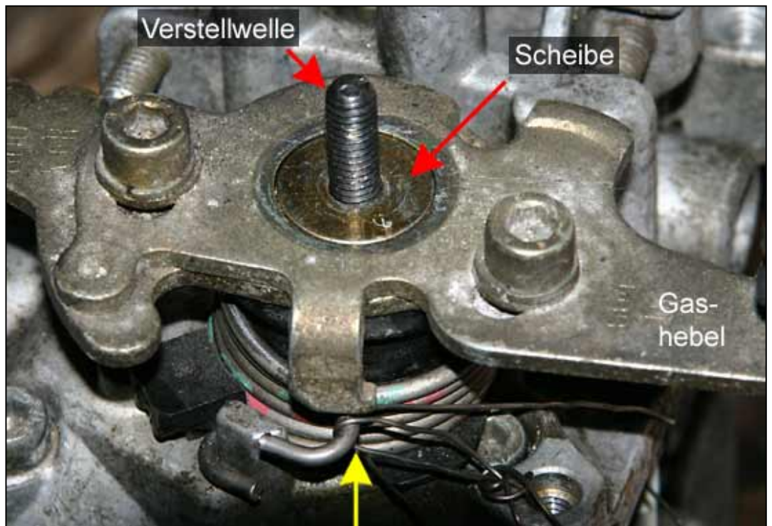
Bild 6: Spannfeder mit Draht zurückgezogen (Pfeil unten). Fies: Die Scheibe versteckt die Markierung des Gashebels zur Welle! (Roter Pfeil)
