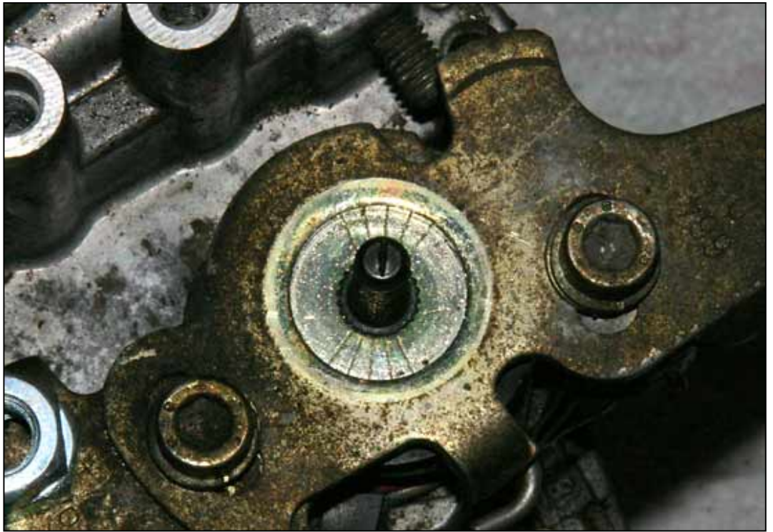
Bild 8: Die Verzahnung und Markierung zwischen Verstellwelle und Gashebel
