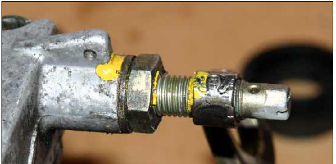
Bild 5: Sieben Umdrehungen herausgedrehte Schraube
