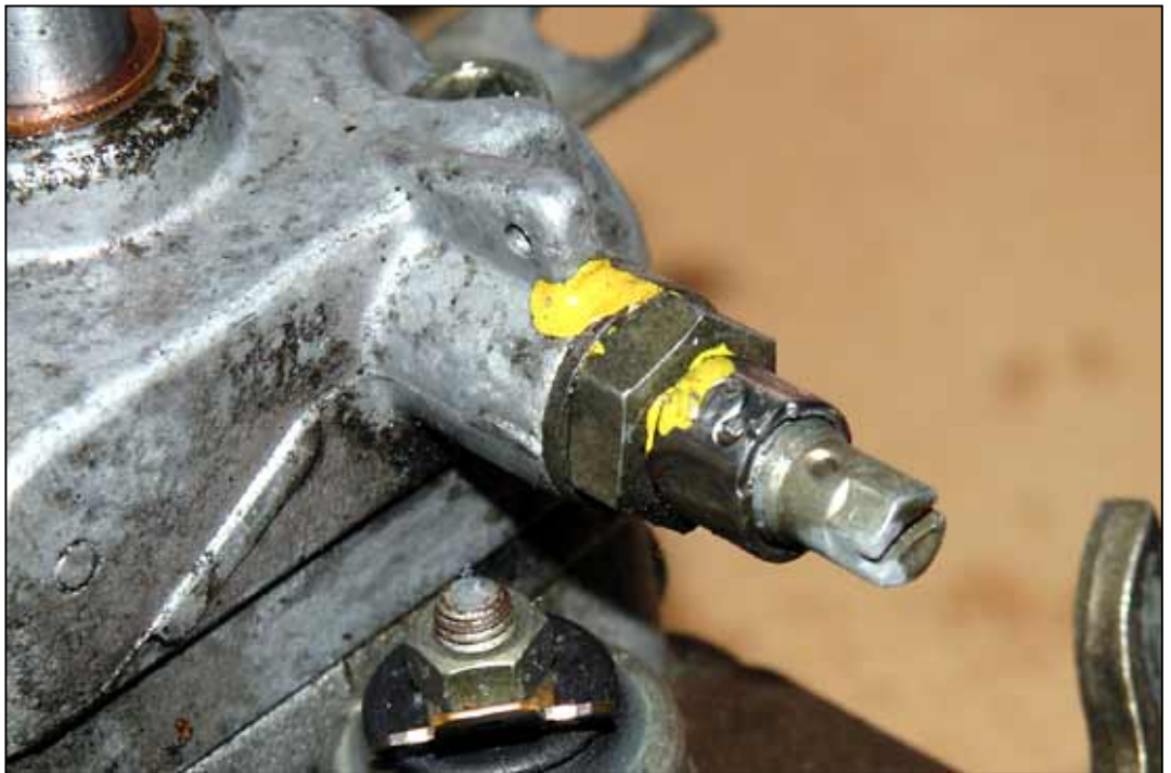
Bild 3: Die Fördermengen-Schraube
