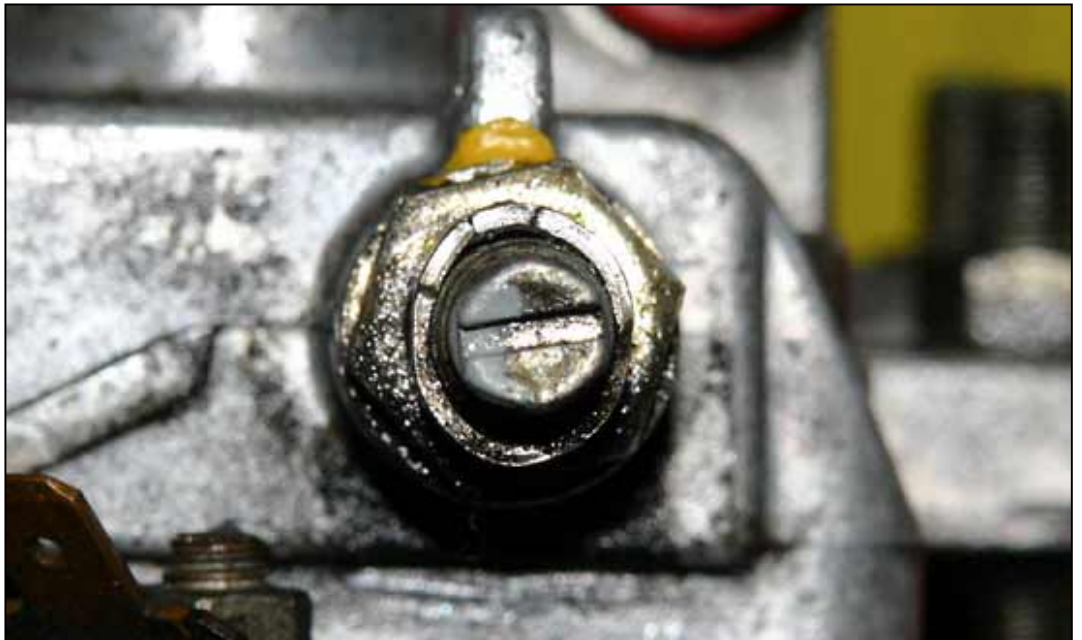
Bild 4: Position der Fördermengen-Schraube markieren (graue Farbe) und merken!
