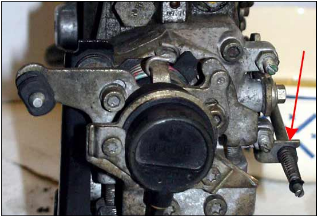
Bild 2: Stange des KSB aushängen
