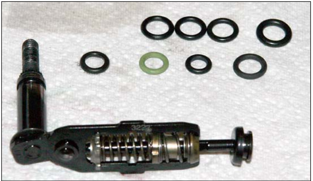
Bild 14: Die ausgebaute Verstellwelle und die möglichen O-Ringe
