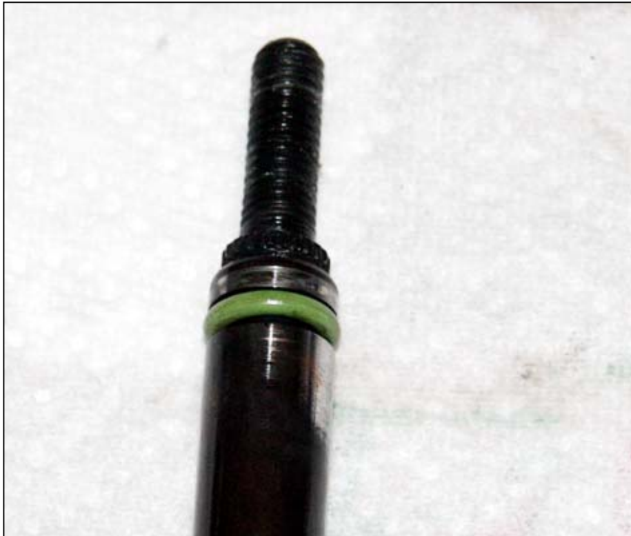
Bild 15: Dieser O-Ring ist der richtige
