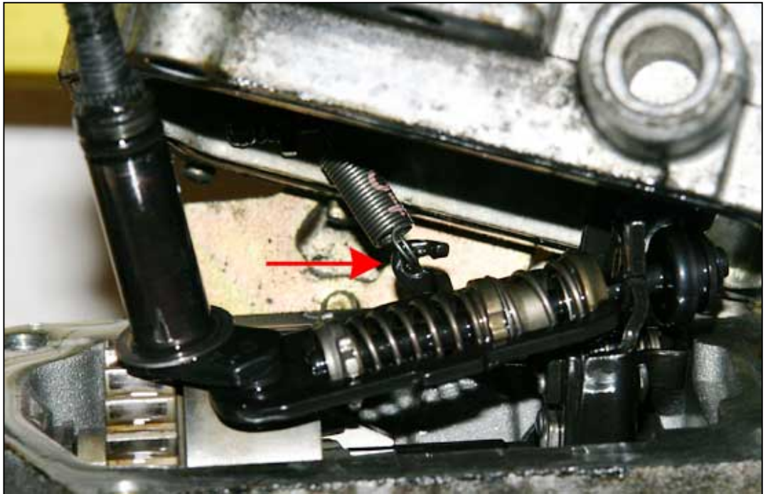
Bild 11: ... die Feder muss noch ausgehängt werden
